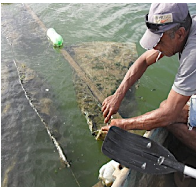
Figura 22. Biofilme aderido a cortinas de plástico como sistema de biorremediação no Açude Manoel Marcionilo, Paraíba, Brasil. (Foto: Cristina Crispim, 2012).
